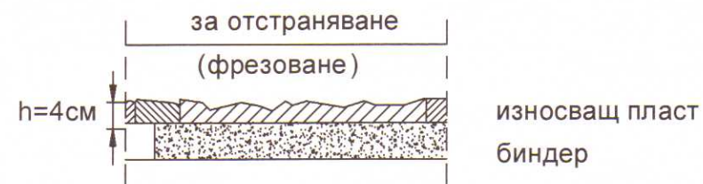
ДЕТАЙЛ No1 - Фрезование на повредени площи
