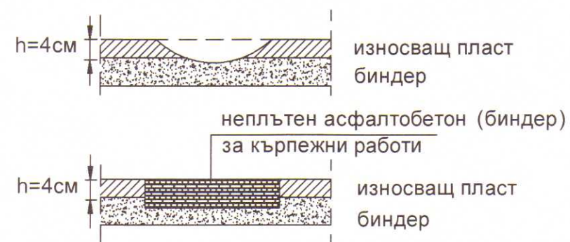
ДЕТАЙЛ No4 -Изкърпване на дупки
